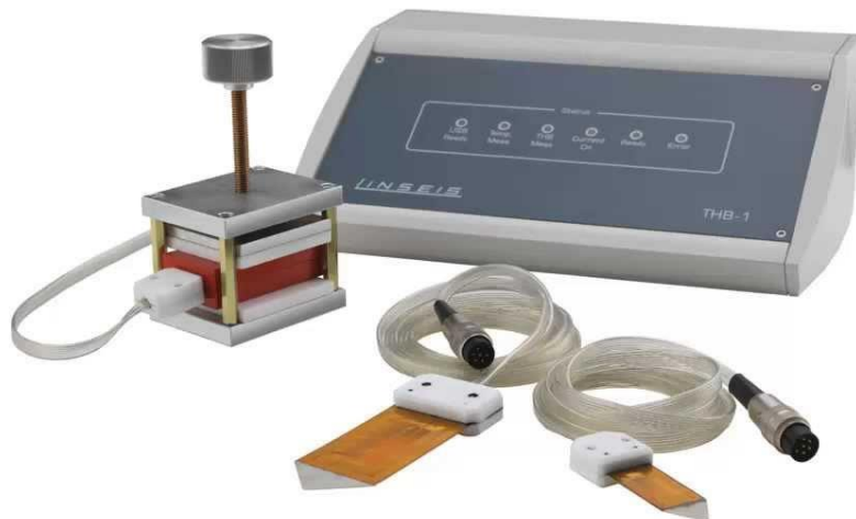
Slika 2.2.3. Uređaj za mjerenje toplinske vodljivosti Linseis THB
