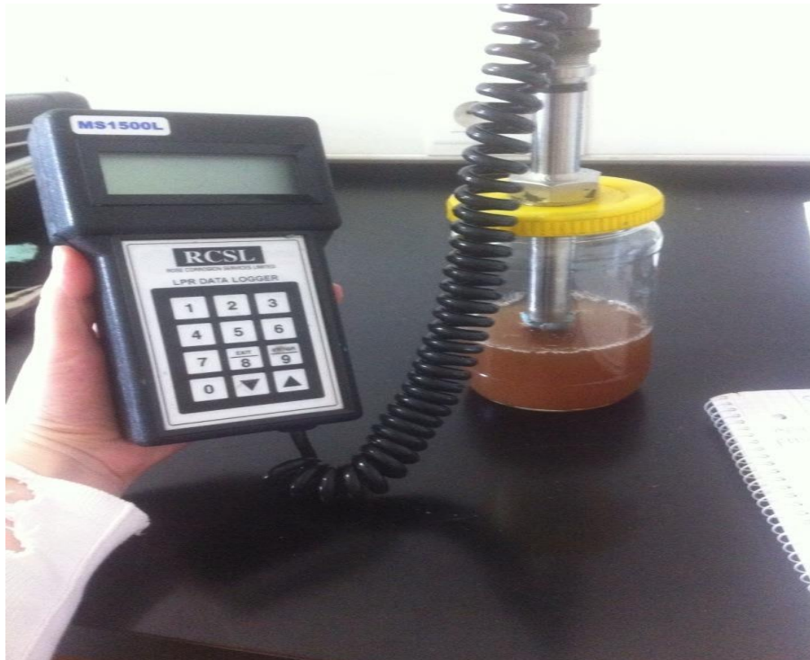
Slika 9. Izgled aparature za korozijski monitoring LPR probom
