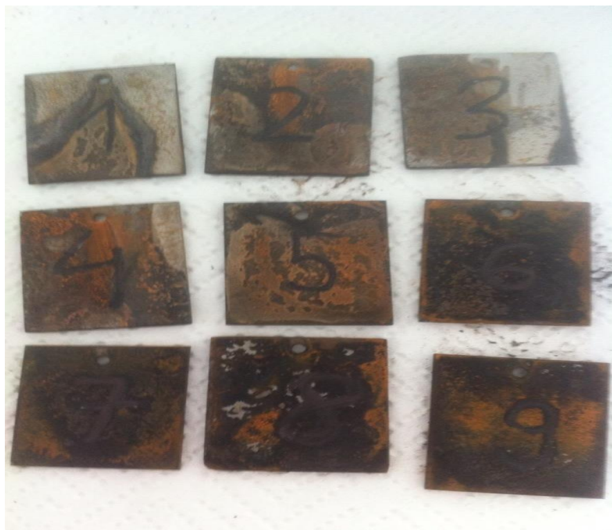
Slika 8. Pločice ugljičnog čelika sa formiranim zaštitnim slojem nakon 7 dana stajanja u otopini 0,5M NaCl (1- 0,5M NaCl; 2- otopina propolisa; 3- propolis+PEG; 4-propolis+škrob; 5-propolis+PEG+škrob; 6-PTB; 7-PTB+PEG;8-PTB+ŠKROB; 9-PTB+PEG+ŠKROB).
