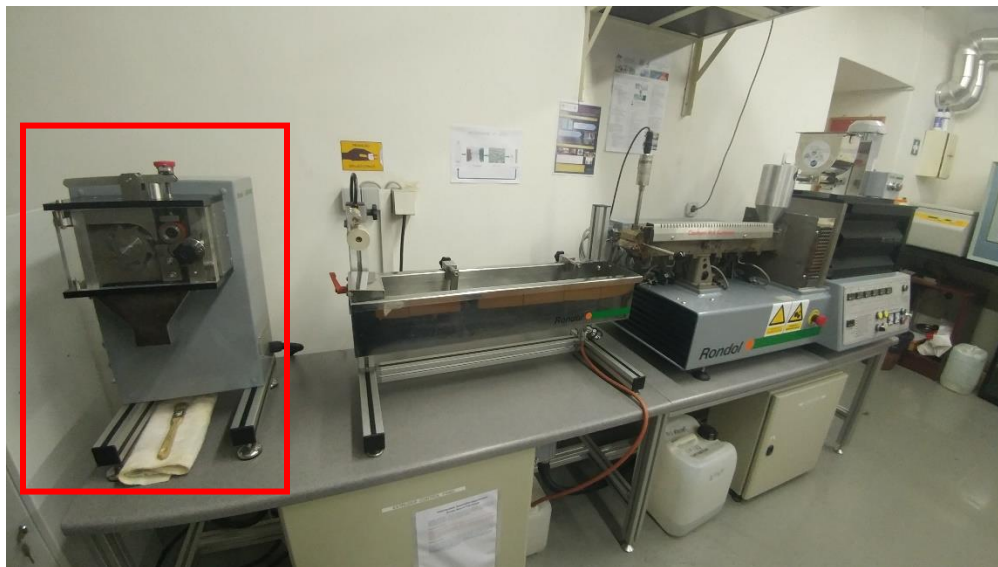
Slika 15. Sjekač spojen na ekstruder Rondol
