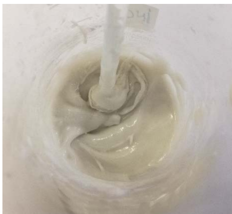
Slika 15. Mješavina rastaljenog PEG-a i DNR-a
