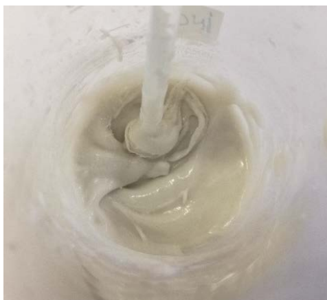
Slika 15. Mješavina rastaljenog PEG-a i DNR-a
