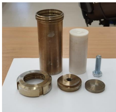
Slika 3.3. Sastavni dijelovi autoklava
