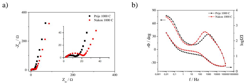
**Slika 4.15.** Rezultati elektrokemijske impedancijske spektroskopije prikazani u **a)** Nyquistovom dijagramu i **b)** Bodeovom dijagramu za superkondenzator SC-4
