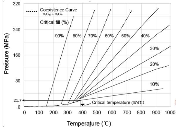
**Slika 2.7.** Ovisnost tlaka o temperaturi za različite volumene vode u autoklavu [13]
