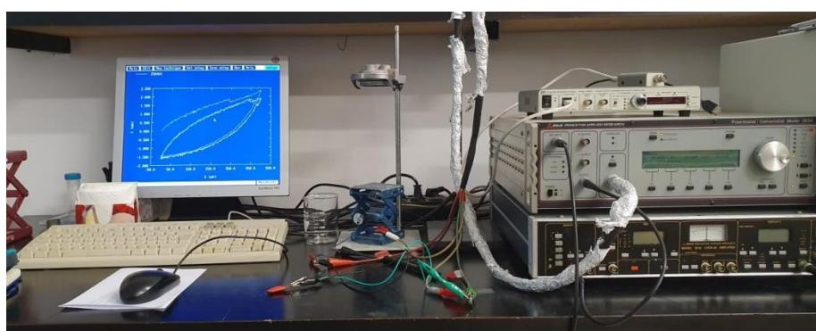
**Slika 3.6.** Ispitivanje superkondenzatora metodom cikličke voltametrije
