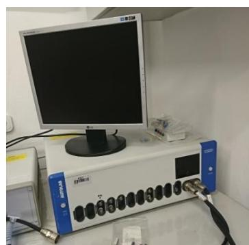
**Slika 3.7.** Potenciostat/galvanostat Autolab
