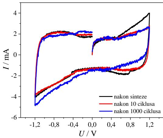
*Slika 4.17.* Ciklički voltamogrami odziva superkondenzatora *SC-4-Fe* u širokom području potencijala
