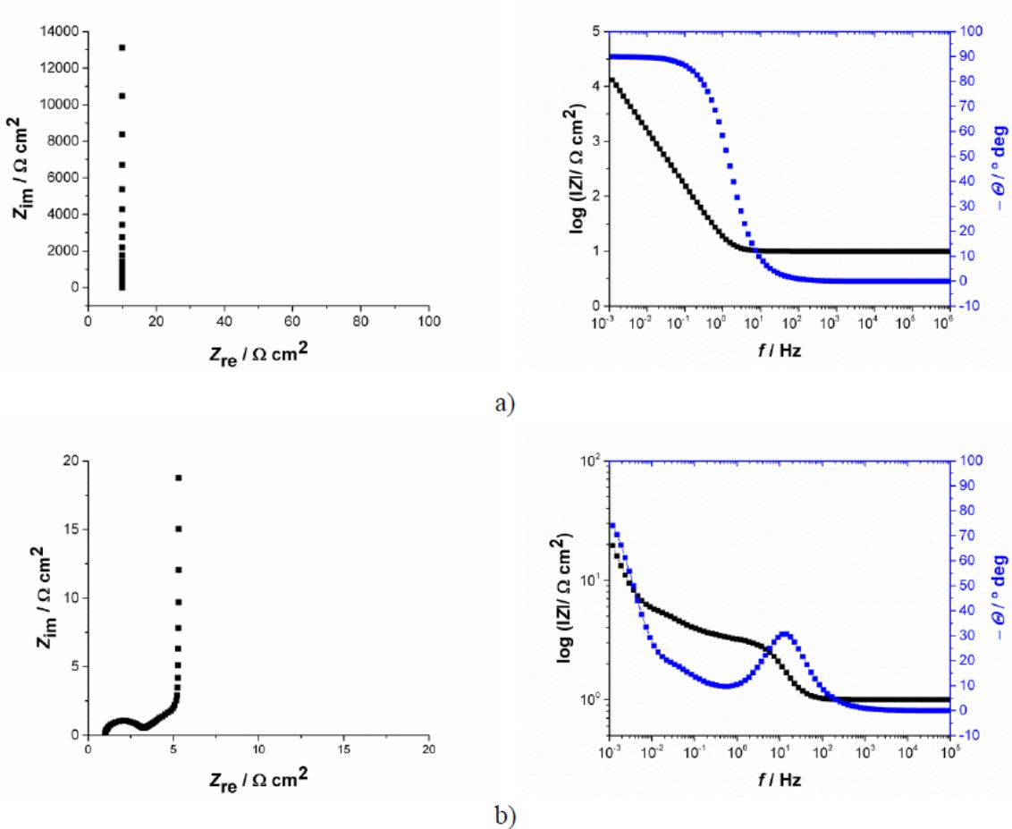
**Slika 2.20.** Nyquistov i Bodeov dijagram za jednostavne elektrokemijske sustave; **a)** idealni kondenzator u seriji s otpornikom, **b)** serijski spoj otpornika, kondenzatora i paralelne kombinacije kondenzatora i otpornika [7]
