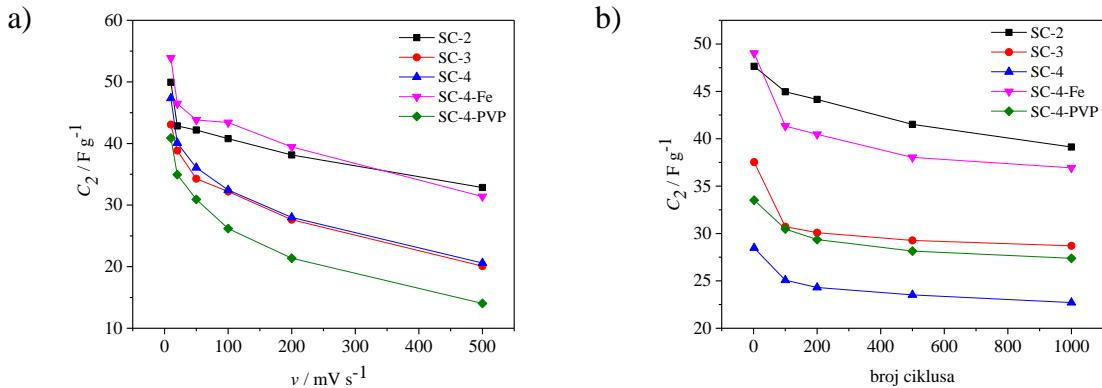
**Slika 5.1. a)** Ovisnost  $C_s$  (dobivena iz cikličkog voltamograma) o brzini promjene potencijala i **b)**  $C_s$  superkondenzatora (dobivena iz kronopotenciometrije) u ovisnosti o broju ciklusa punjenja/praznjnenja
