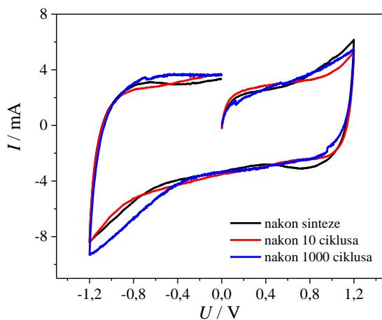
**Slika 4.13.** Ciklički voltamogrami odziva superkondenzatora SC-4 u širokom području potencijala
