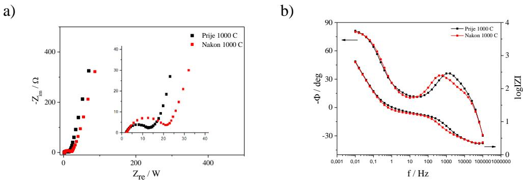
*Slika 4.11.* Rezultati elektrokemijske impedancijske spektroskopije prikazani u **a)** Nyquistovom dijagramu i **b)** Bodeovom dijagramu za superkondenzator SC-3
