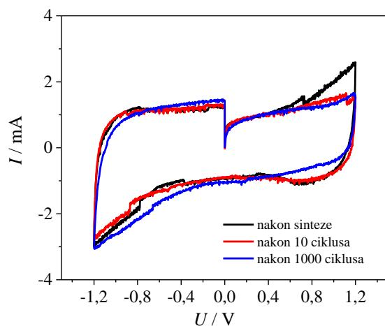
*Slika 4.5.* Ciklički voltamogrami zabilježeni tijekom ispitivanja superkondenzatora SC-2 u širokom području potencijala,  $v=50 \text{ mV s}^{-1}$ .
