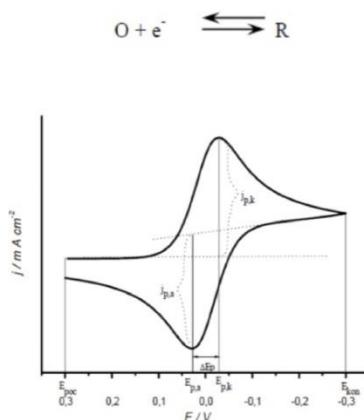
**Slika 2.15.** Ciklički voltamogram za reverzibilni elektrodnji proces
