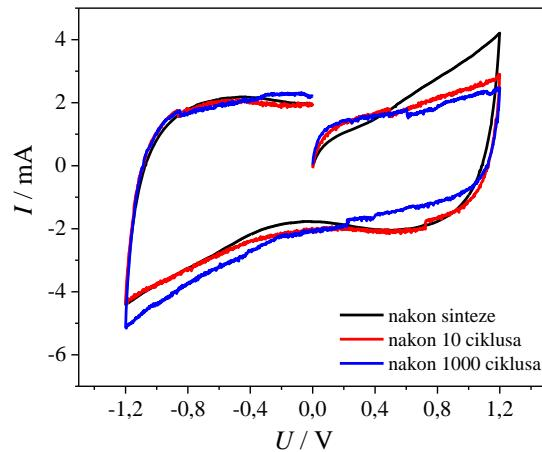
**Slika 4.21.** Ciklički voltamogrami odziva superkondenzatora SC-4-PVP u širokom području potencijala
