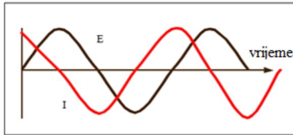
*Slika 2.18.* AC val za narinuti potencijal,  $E$  i rezultirajuću struju,  $I$
