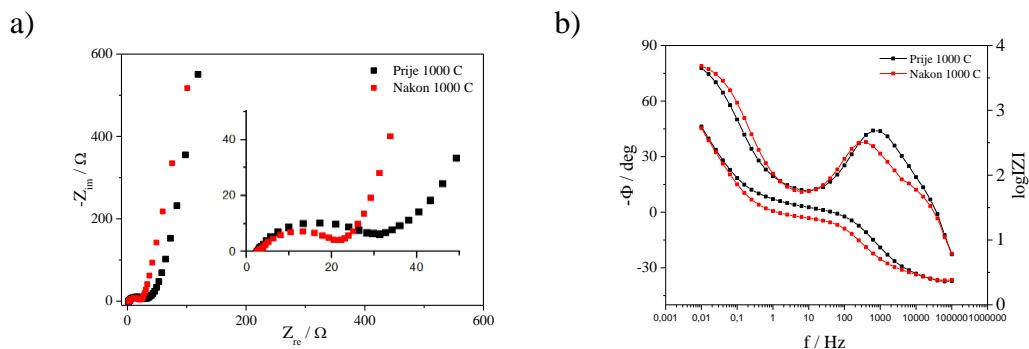
**Slika 4.23.** Rezultati elektrokemijske impedancijske spektroskopije prikazani u **a)** Nyquistovom dijagramu i **b)** Bodeovom dijagramu za superkondenzator SC-4-PVP
