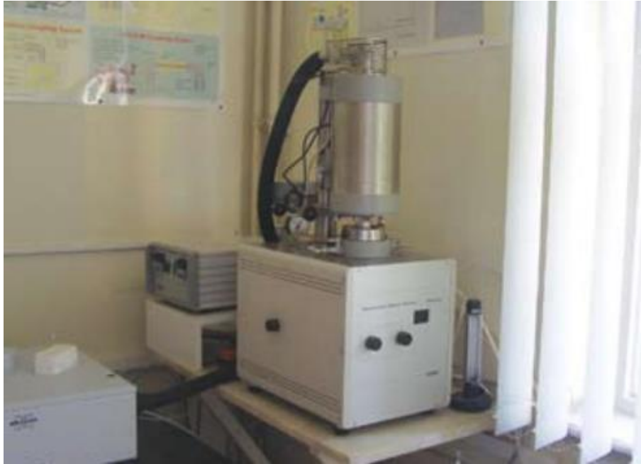
Slika 5. Termogravimetrijski analizator (TGA) NetzschSTA409 [29].
