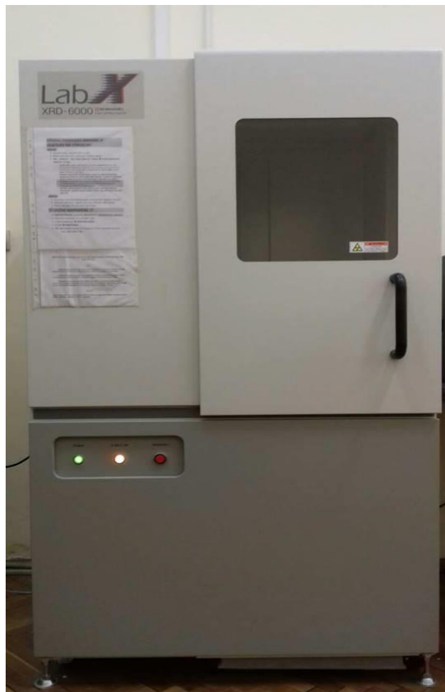
Slika 2. Rendgenski difraktometar, Shimatzu XRD 6000
