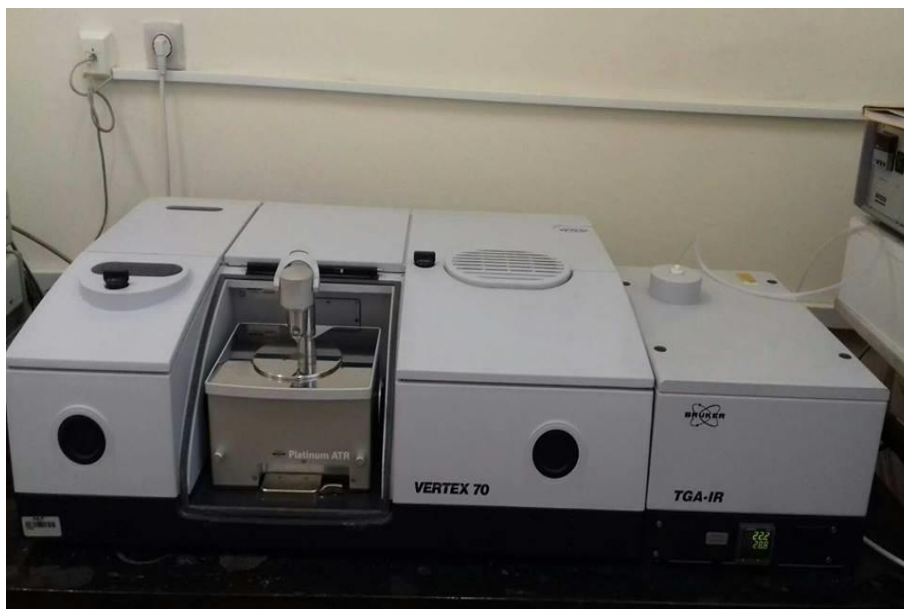
Slika 3. IC spektrofotometar s Furierovom transformacijom signala (FTIR) Bruker Vertex 70.
