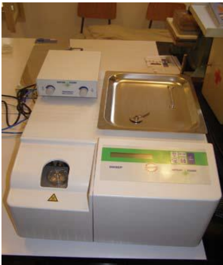
Slika 6. Diferencijalni pretražni kalorimetar (DSC) Mettler Toledo DSC823 e [29].
