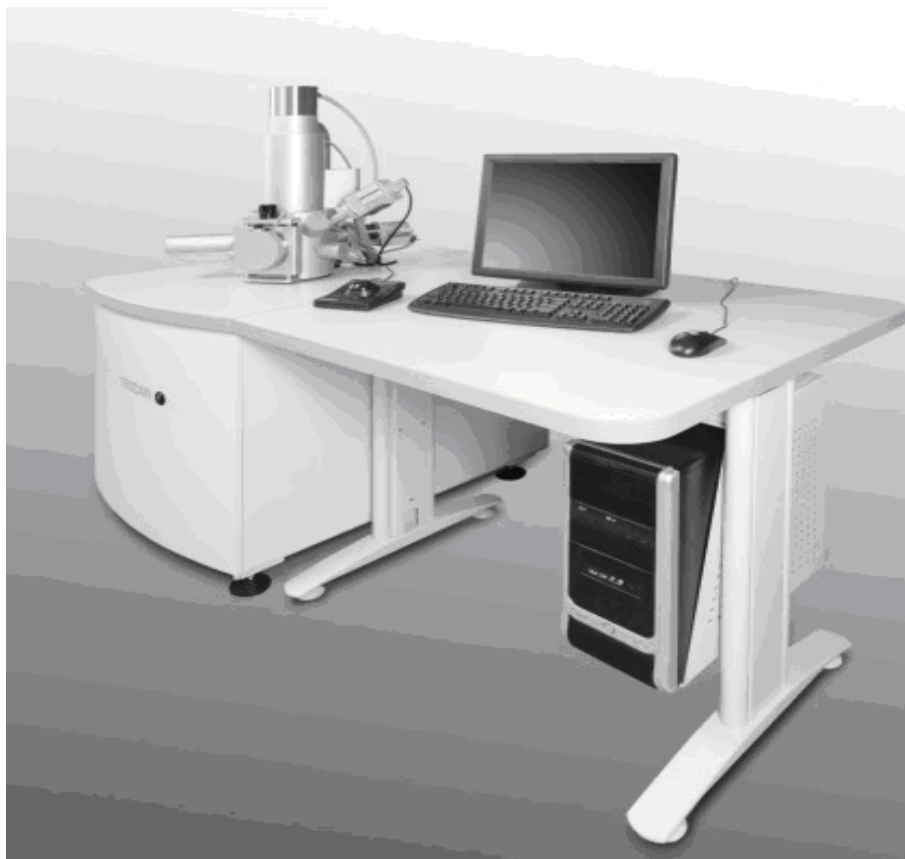
Slika 4. Pretražni elektronski mikroskop, Tescan Vega III Easyprobe [29].
