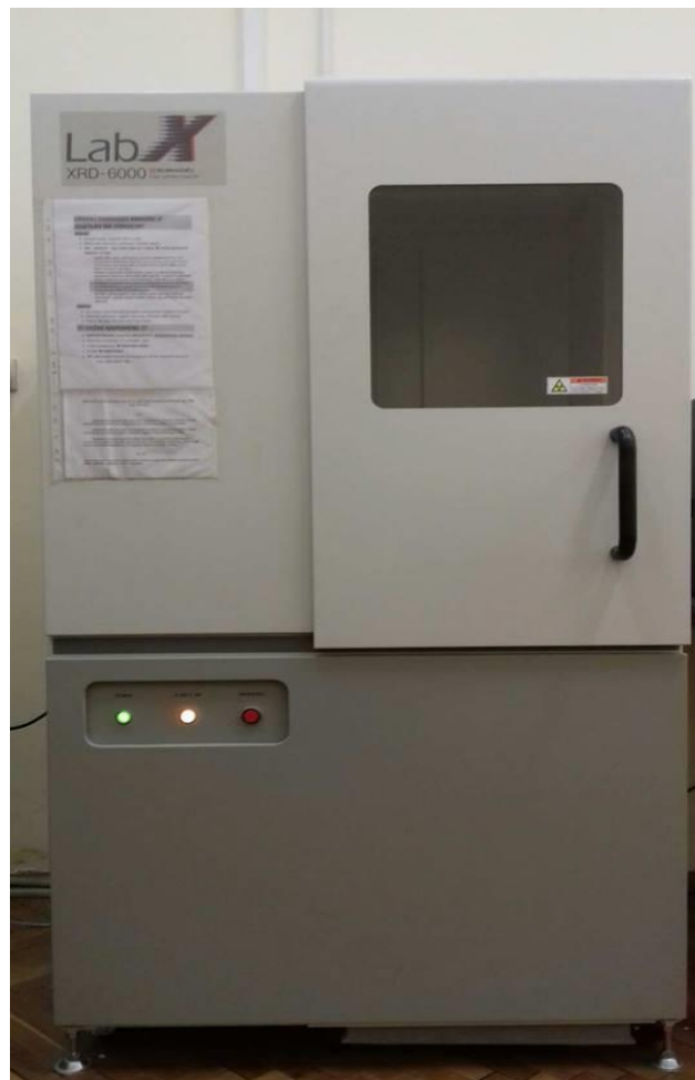
Slika 2. Rendgenski difraktometar, Shimatzu XRD 6000
