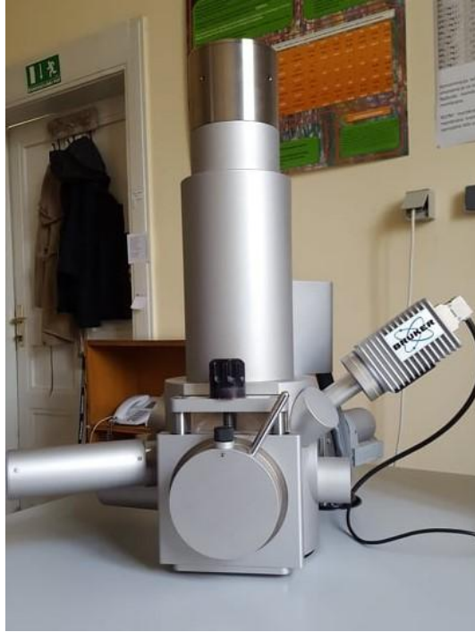
Slika 7. Pretražni elektronski mikroskop Tescan Vega III Easyprobe
