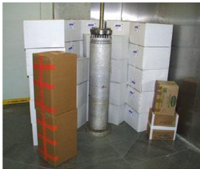
Slika 8. Izvor gama zračenja ^{60}\text{Co} u Laboratoriju za za radijacijsku kemiju i dozimetriju Instituta Ruđer Bošković 31
