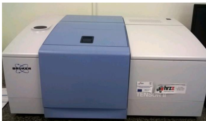
Slika 12 Tenzor II spektrometar u Laboratoriju za procese taloženja Instituta Ruđer Bošković 34
