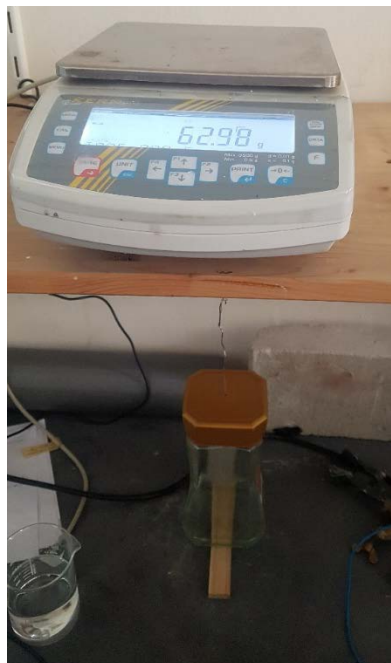
Slika 40. Kiveta s PC uronjena u vodu kroz konično dno u zatvorenom sustavu
