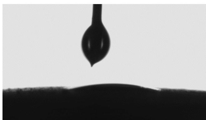
**Slika 62:** Kontaktni kut tablete cementa sa acetonom
