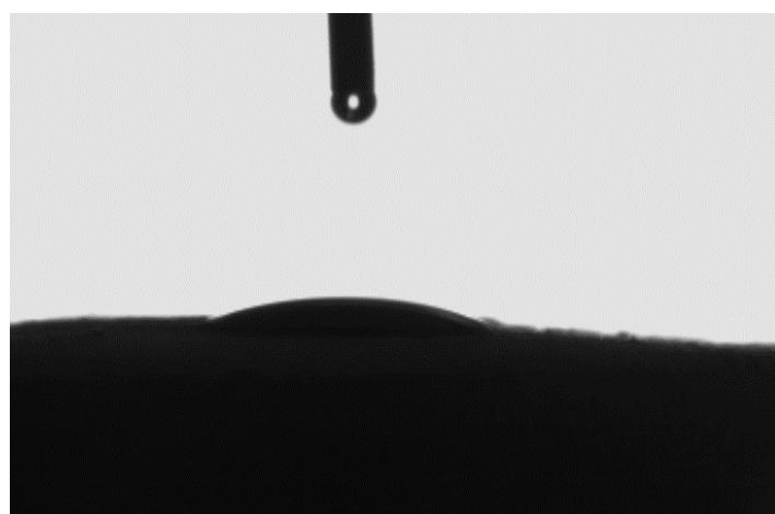
**Slika 66:** Kontaktni kut tablete cementa sa dijodometnom
