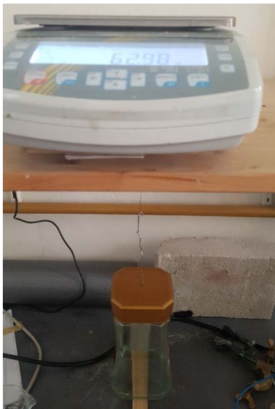
Slika 41. Uzorak PC uronjen u etil alkohol
