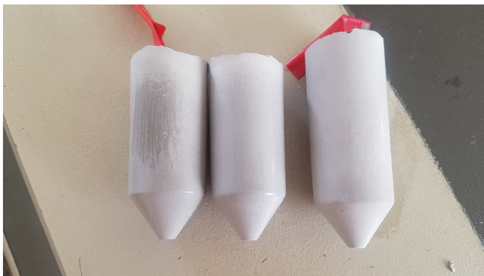
Slika 48. Uzorci PC nakon kalorimetrije a) Uzorak PC koji je centrifugiran b) PC koji je centrifugiran i dekantiran c) PC zamiješan na zraku
