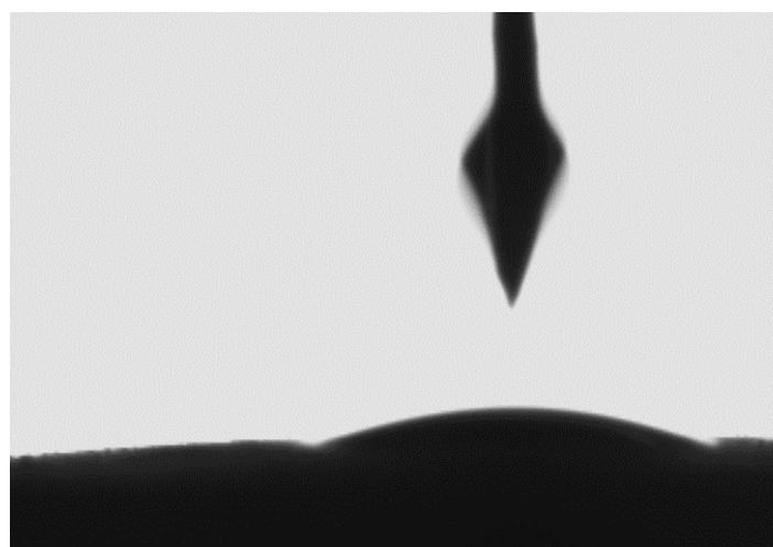
**Slika 65:** Kontaktni kut tablete cementa sa n-heksnom
