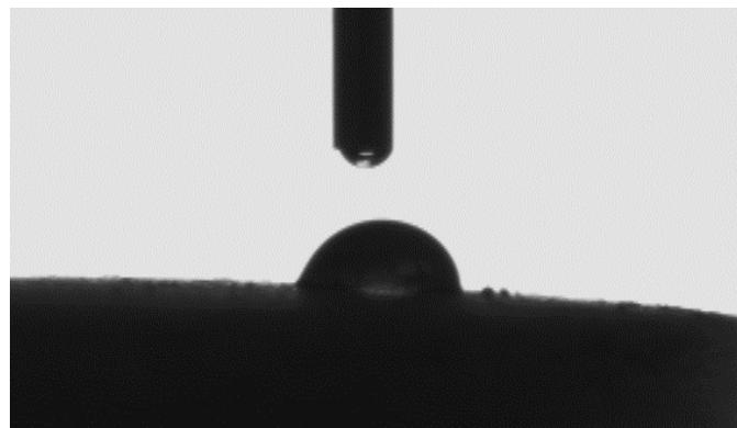
**Slika 68:** Kontaktni kut tablete cementa sa vodom
