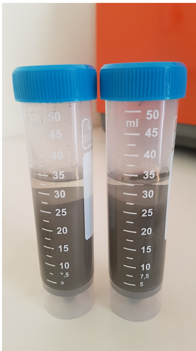
Slika 35. Uzorak a) PC+VODA b) PC+voda+ plastifikator
