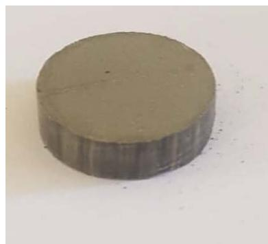
**Slika 43.** Tableta napravljena od cementa
