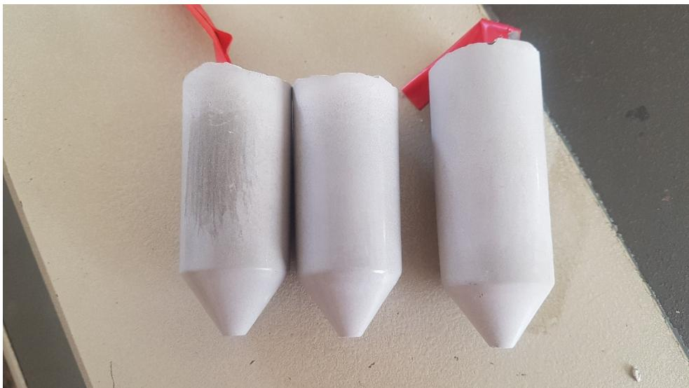
**Slika 48.** Uzorci PC nakon kalorimetrije a) Uzorak PC koji je centrifugiran b) PC koji je centrifugiran i dekaniran c) PC zamiješan na zraku
