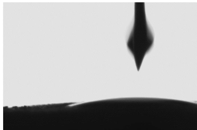
**Slika 64:** Kontaktni kut tablete cementa sa heptanom
