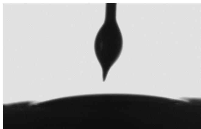
**Slika 63:** Kontaktni kut tablete cementa sa cikloheksanom
