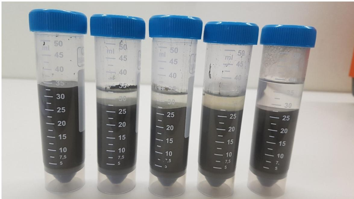
**Slika 45.** Uzorci portland cementa a) ručno izmješan i ostavljen na zraku, b) portland cement + voda izmiješan u centrifugiji u 10 ciklusa, c) uzorak portland cementa s vodom centrifugiran u jednom ciklusu, d) uzorak PC+voda+plastifikator c) uzorak PC + etilni alkohol
