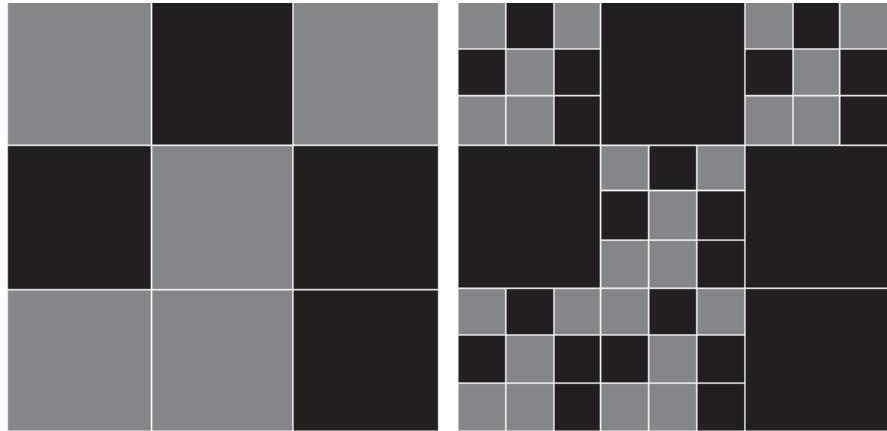
**Slika 23.** Shematska ilustracija fraktalnog modela čvrstih masa. Siva boja označava ponavljaljuću fazu a crna označava fazu pora<sup>23</sup>
