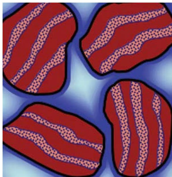
**Slika 2.** Rasподjela vode unutar C-S-H nanostrukture<sup>16</sup>
