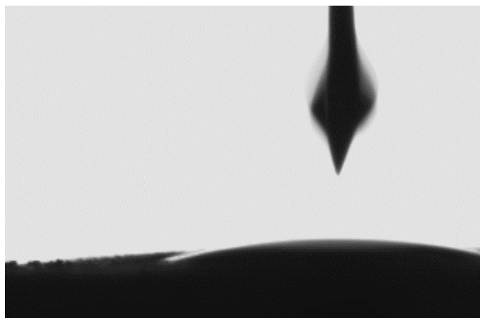
Slika 64: Kontaktni kut tablete cementa sa heptanom
