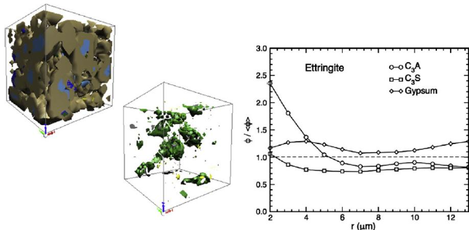
**Slika 16.** Simulacija HydratiCA idealizirane paste cementnog portland cementa<sup>2</sup>
