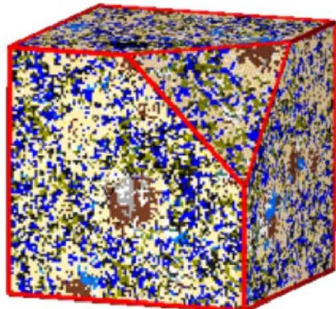
**Slika 14.** Cemhyd3d model portland cementne paste nakon 14 dana hidratacije<sup>2</sup>
