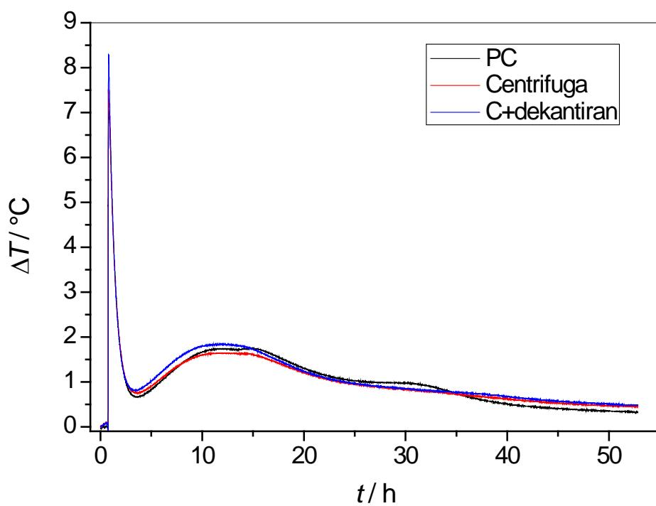
**Slika 47.** Grafički prikaz rezultata dobivenih kalorimetrijom a) PC+voda zamiješani na zraku
