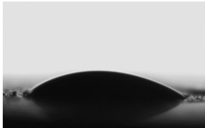
**Slika 67:** Kontaktni kut tablete cementa sa glicerolom
