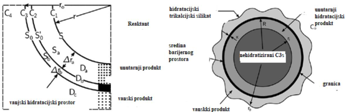
Slika 3. Rast hidrata jednake debljine na pojedinačnoj sfernoj čestici<sup>2</sup>
