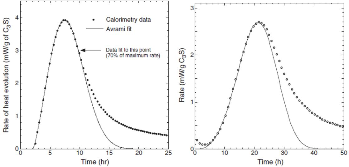
**Slika 8.** Primjena jednadžbe JMAK nukleacije i rasta na podatke izotermne kalorimetrije za hidrataciju  $\text{C}_3\text{S}^2$
