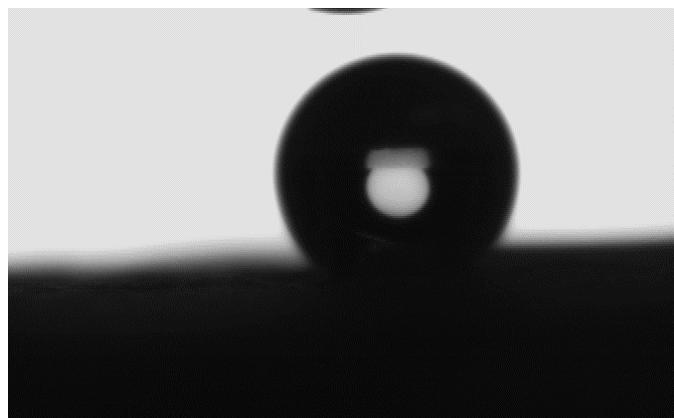
**Slika 61:** Kontaktni kut tablete cementa sa formamidom
