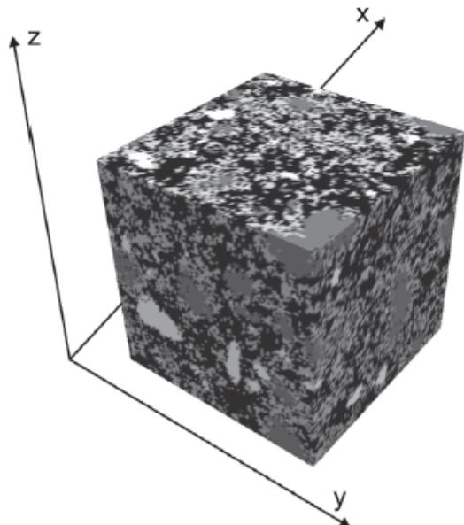
**Slika 19.** VCCTL model za vapneničku cementnu pastu<sup>3</sup>
