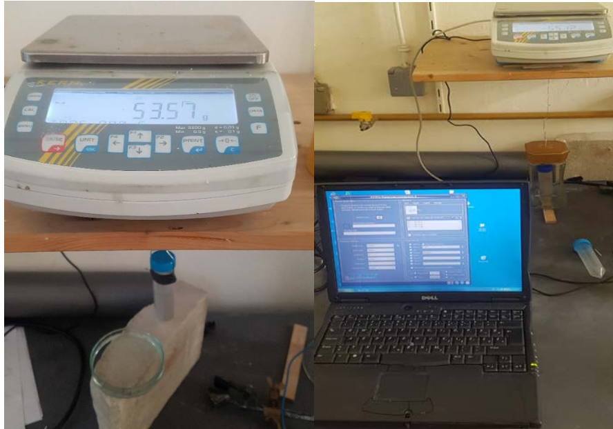
Slika 38. Kiveta sa PC uronjena u vodu kroz konično dno (lijevo), program za mjerenje promjene mase (desno)
