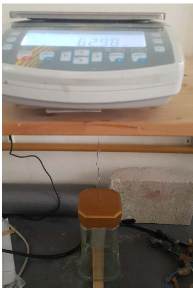
Slika 41. Uzorak PC uronjen u etil alkohol
