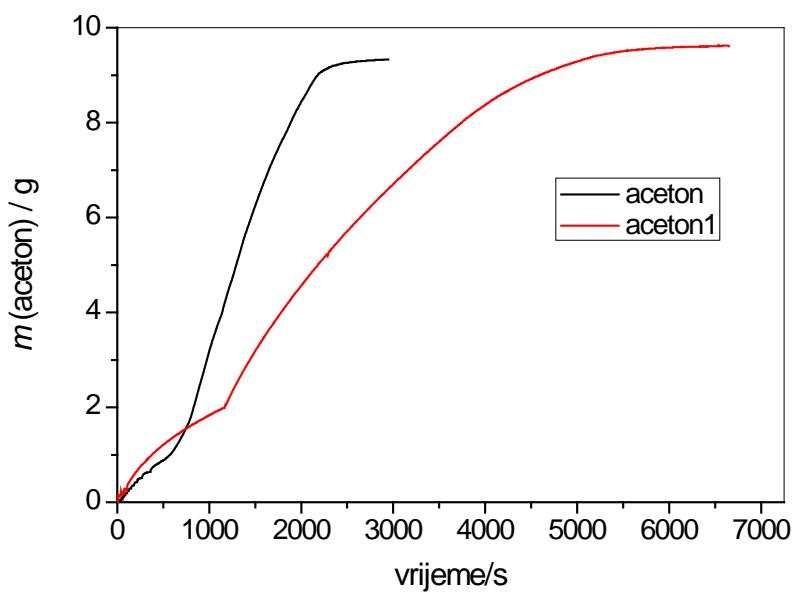
**Slika 52.** Grafički prikaz rezultata dobivenih mjeranjem promjene mase PC kad se kapilarno upija aceton
