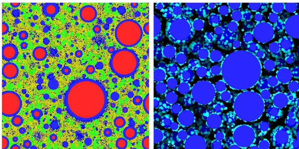
**Slika 17.** Simulacije mikrostrukturna s finim punilima i velikim brojem čestica (lijevo) i kontrolirane nukleacije na površini čestica (desno), simulirane pomoću platforme za modeliranje  $\mu$ ic<sup>2</sup>
