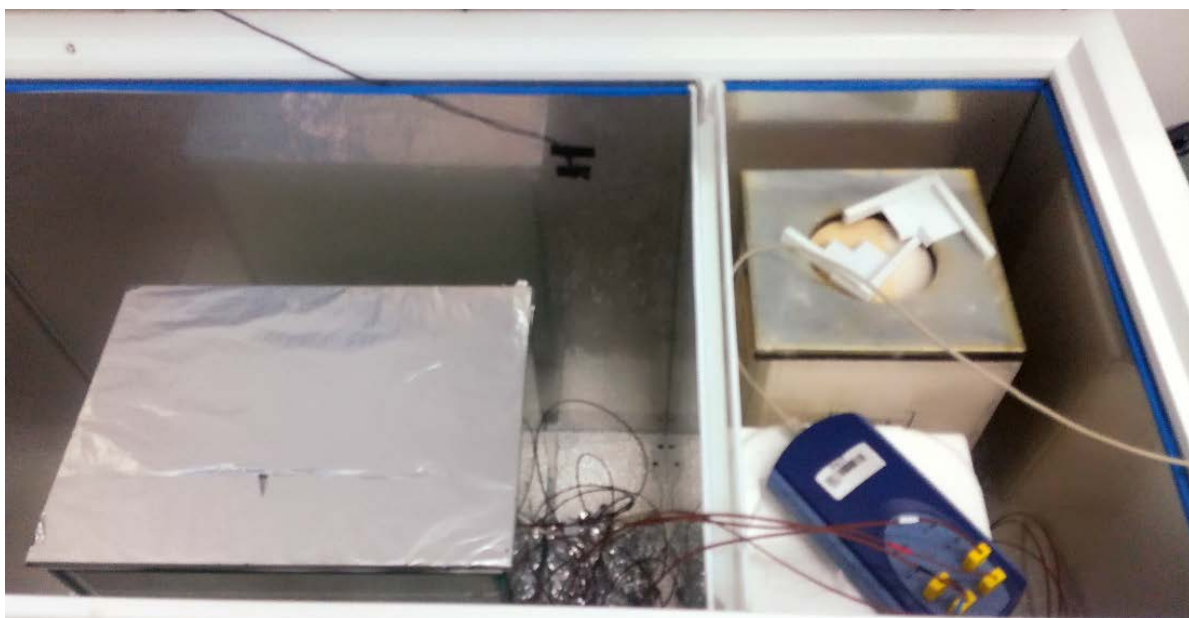
Slika 36. Kalorimetar vlastite izvedbe, Zavod za anorgansku kemijsku tehnologiju i nemetale, Fakultet kemijskog inženjerstva i tehnologije
