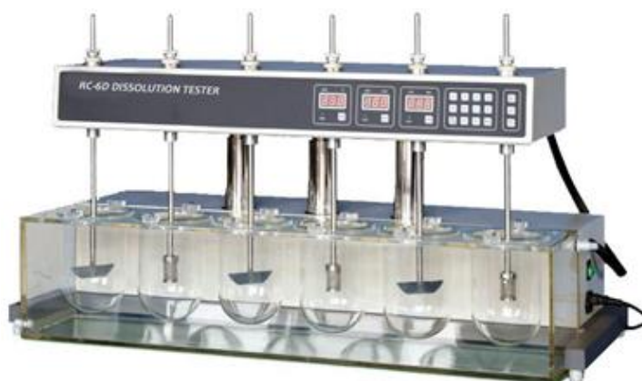
Slika 12. Uređaj za ispitivanje oslobađanja djelatnih tvari RC-6D , Zhengzhou Nanbei Instrument
