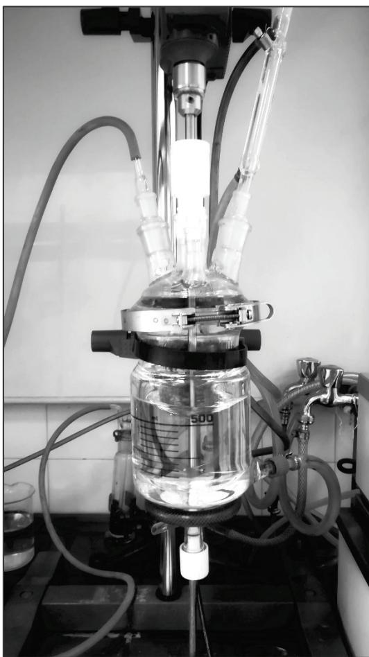
Slika 37. Laboratorijski reaktor za polimerizaciju (500 mL)
