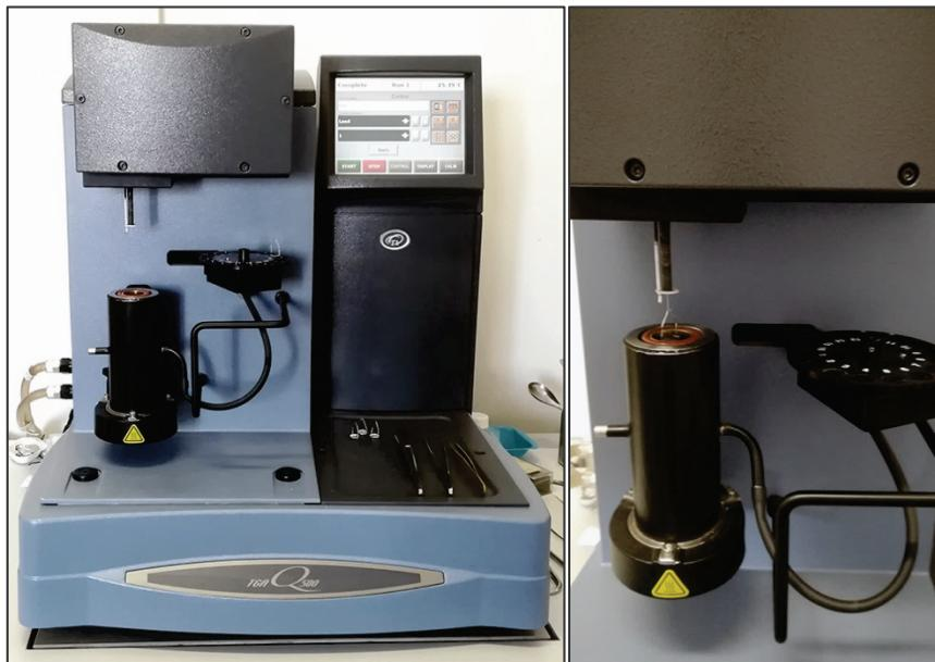
Slika 53. Laboratorijski TGA (lijevo) s približenom peći, kukicom za vagu i postoljem za uzorkovanje (desno)
