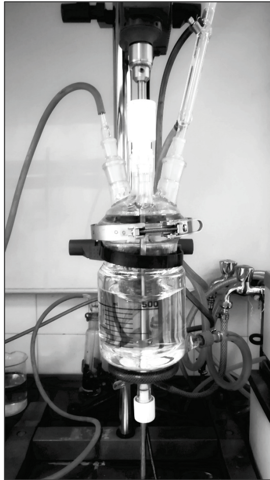
Slika 37. Laboratorijski reaktor za polimerizaciju (500 mL)
