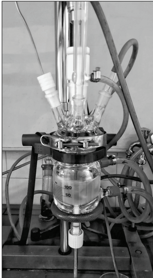
Slika 35. Laboratorijski reaktor za polimerizaciju (100 mL)
