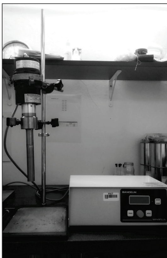
Slika 34. Ultrazvučna sonda za homogenizaciju suspenzije
