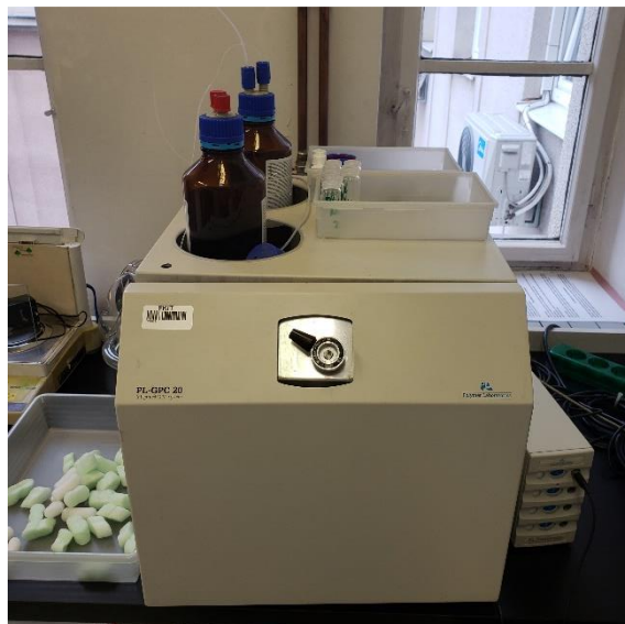
Slika 3.2.6.2. Uređaj PL-GPC 20 Polymer Laboratories
