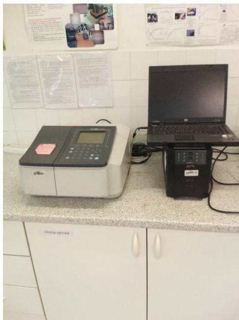
Slika 3.2.3.1. UV/Vis spektrofotometar Shimadzu UV-1800
