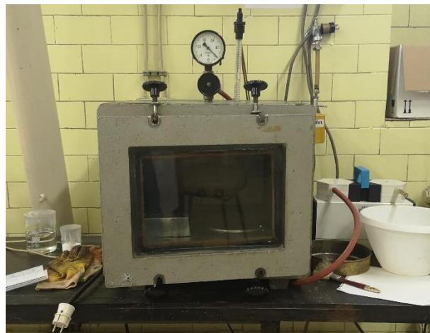
**Slika 3.2.** Vakuum sušionik
