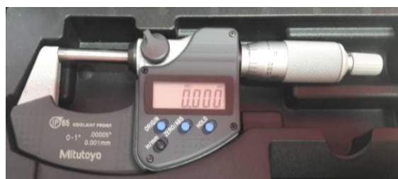
Slika 29. a) Pripremljeni uzorci za mehaničko ispitivanje b) digitalni mikrometar, Mitutoco Coolant Proof Micrometer
