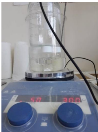
Slika 23. Homogenizacija otopina na magnetskoj miješalici
