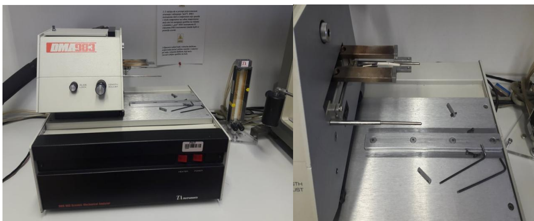
Slika 27. Dinamičko mehanički analizator, DMA 983, TA Instruments
