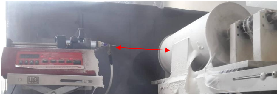
Slika 25. Pumpa na kojoj je šprica s iglom ravnog dna
