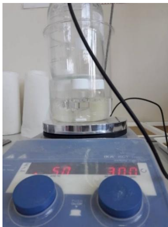
Slika 23. Homogenizacija otopina na magnetskoj miješalici
