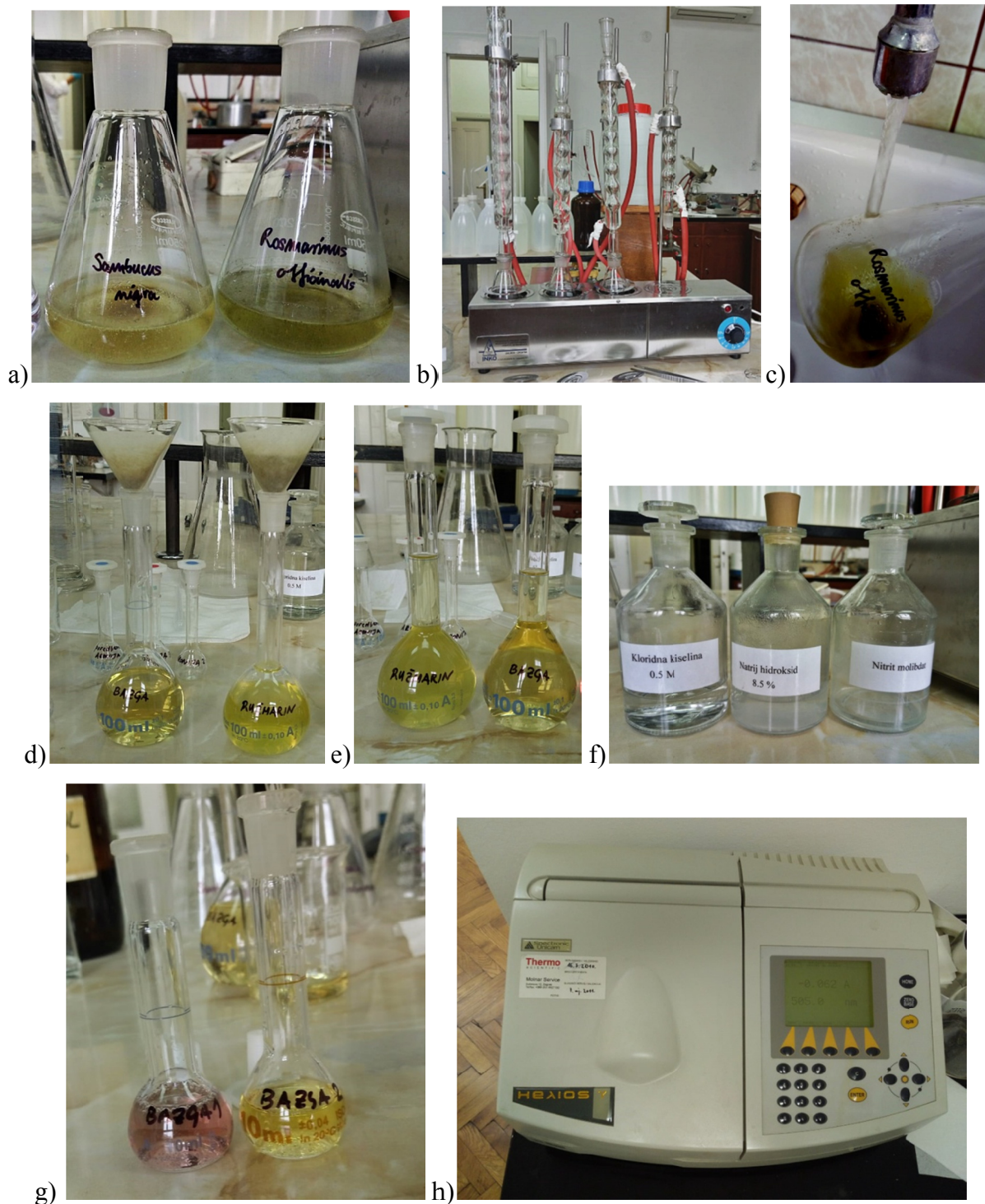
Slika 12. Određivanje fenolnih kiselina; (a) priprema uzorka za ekstrakciju; (b) ekstrakcija na vodenoj kupelji uz povratno hladilo; (c) hlađenje tikvice pod mlazom hladne vode; (d) filtriranje alkoholnog ekstrakta; (e) dopunjavanje 50 %-tnim etanolom do oznake; (f) reagensi; (g) priprema poredbena i ispitivane otopine; (h) mjerenje apsorbancije otopina
