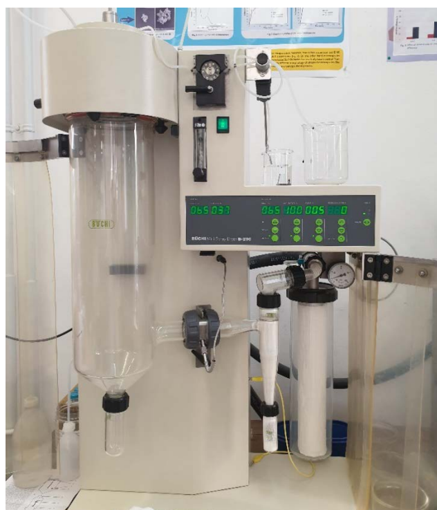
Slika 9. Sušionik s raspršivanjem Mini Spray Dryer B-290
