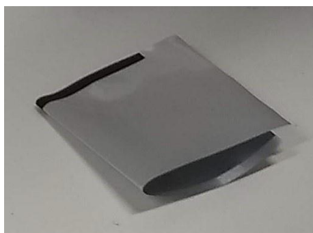
Slika 3.2.1. „Coffee bag“ kućište za galvanski članak.
