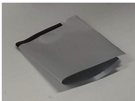
Slika 3.2.1. „Coffee bag“ kućište za galvanski članak.
