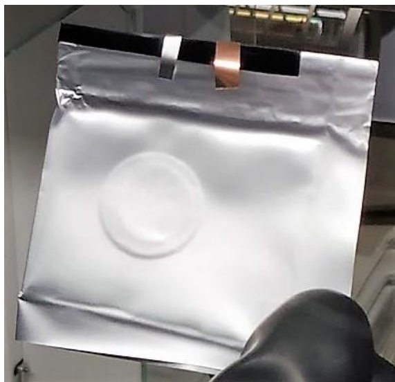
Slika 3.2.4. Gotov galvanski članak.
