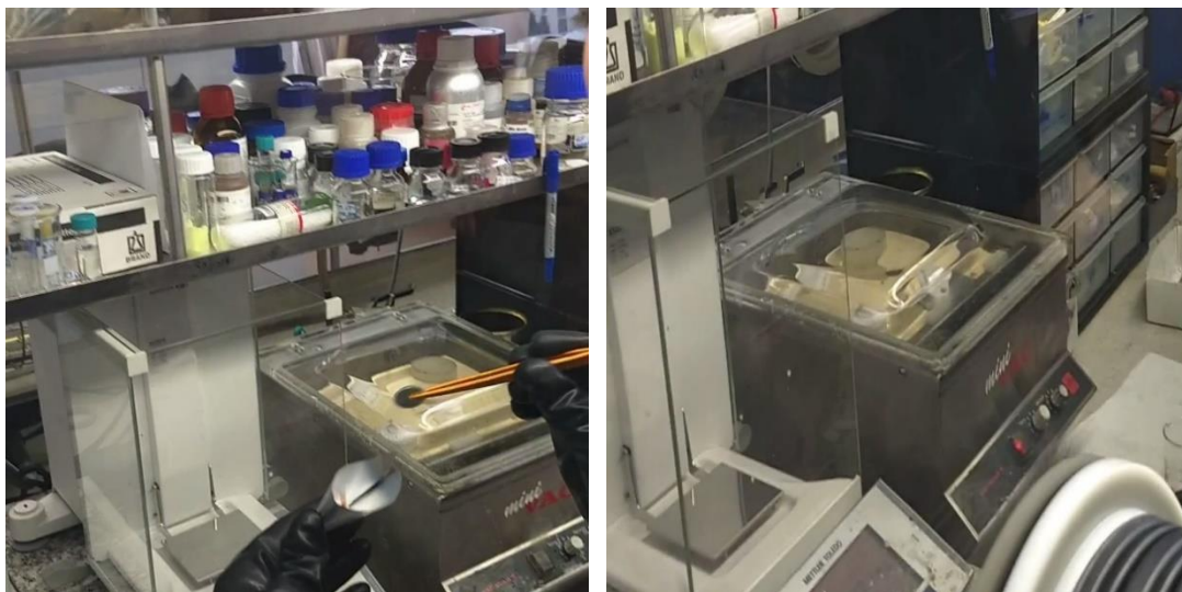
Slike 3.2.3 a i b. Stavljanje čelije u kućište (a) , vakuumiranje i zatvaranje kućišta (b).
