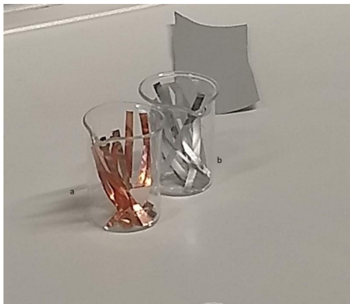
Slika 3.2.2. Narezane trakice bakrene i aluminijske folije (a i b).
