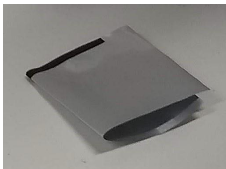
Slika 3.2.1. „Coffee bag“ kućište za galvanski članak.
