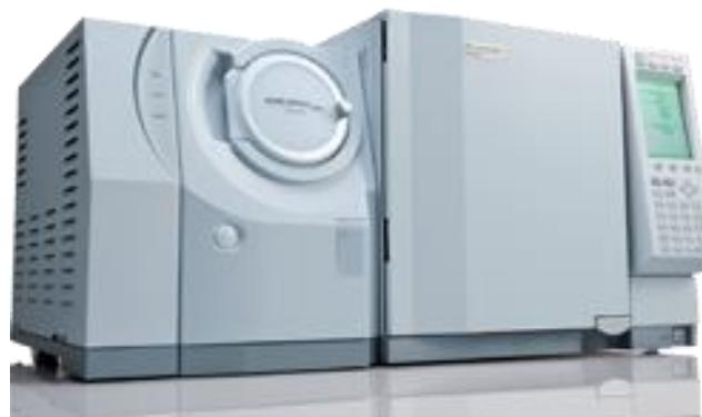
Slika 14. Plinski kromatograf QP 2010 plus sa spektrometrom masa
