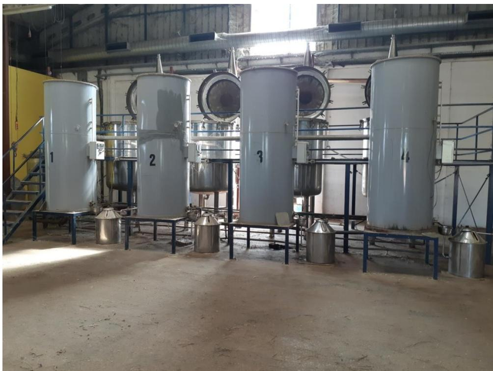
Slika 13. Postrojenje za destilaciju vodenom parom
